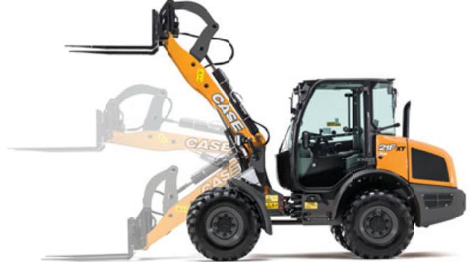
**XT** ist die beste Lösung für den Einsatz mit der Palettengabel. Hervorragende Sicht auf die Palette durch nur einen Hubzylinder. Optimale Nutzlast.
