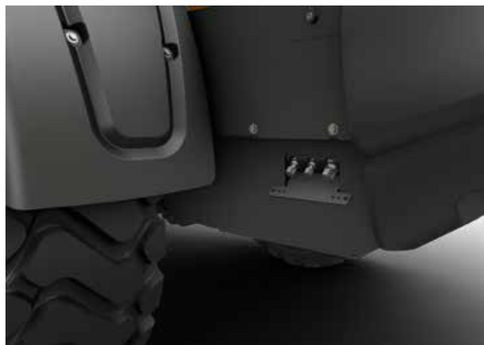
Gruppierte Ablassventile für einen schnellen und sauberen Ölwechsel.
