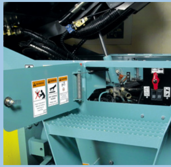
Klappbare Fahrerkabine für eine sichere und einfache Wartung und Instandhaltung
