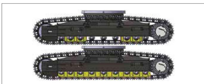
**Kettenschutze:** dienen der Sicherheit, Kettenausrichtung und besserer Fahrleistung der Maschine. 3 Kettenschutze pro Kette gehören zur Serienausrüstung der Modelle DX490LC-7 und DX530LC-7 (durchgehende Kettenschutze sind als Sonderausrüstung erhältlich); der DX420LC-7 hat 2 Schutze pro Kette (doppelte und durchgehende Kettenschutze sind als Sonderausrüstung erhältlich). Diese verschiedenen Kettenschutzoptionen bieten die jeweils optimale Lösung, auch für extreme Anwendungen.
