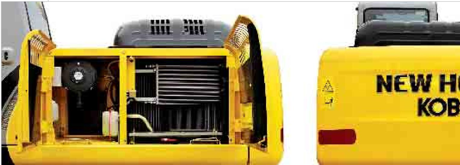
**D**ie vereinfachte Anordnung aller wichtigen Komponenten des Modells E215B von New Holland unter der rechten und linken Seitenabdeckung ermöglicht eine viel einfachere, schnellere und kostengünstigere Wartung und bietet einen weitaus besseren Wartungszugang. Alle Fächer sind sehr geräumig, und die meisten Komponenten sind so positioniert, dass sie vom Boden aus leicht erreichbar sind. **Ein elegantes und modernes Design in Kombination mit hochmoderner Technik.**
