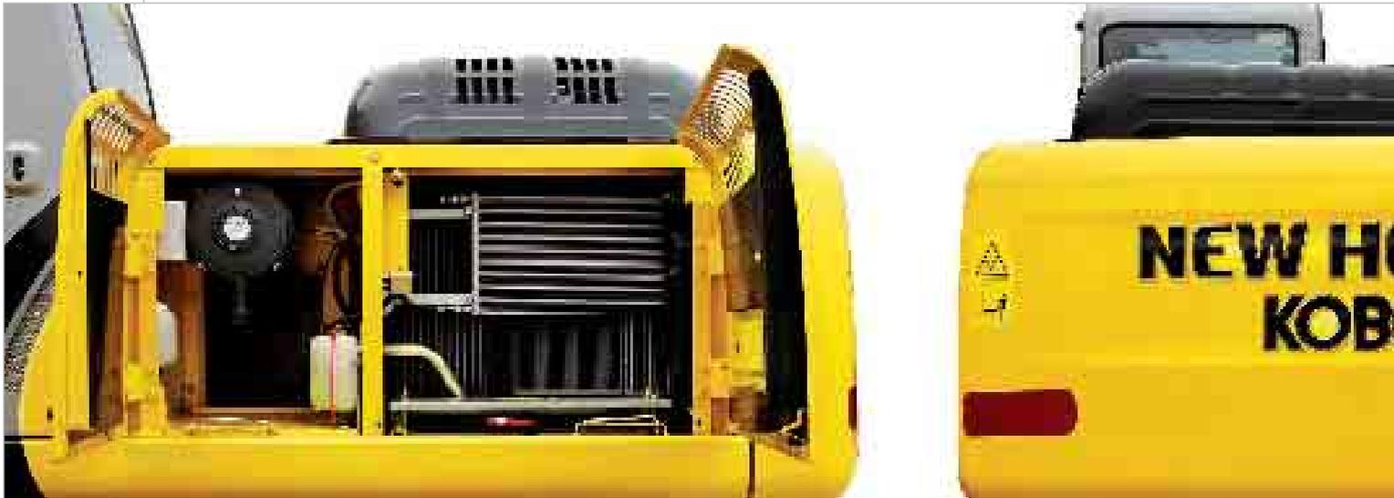
**D**ie vereinfachte Anordnung aller wichtigen Komponenten des Modells E245B von New Holland unter der rechten und linken Seitenabdeckung ermöglicht eine viel einfachere, schnellere und kostengünstigere Wartung und bietet einen weitaus besseren Wartungszugang. Alle Fächer sind sehr geräumig, und die meisten Komponenten sind so positioniert, dass sie vom Boden aus leicht erreichbar sind. **Ein elegantes und modernes Design in Kombination mit hochmoderner Technik.**
