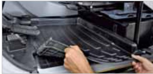
■ Die herausnehmbare, zweiteilige Fußmatte hat Handgriffe und lässt sich problemlos zum Säubern aus der Kabine entfernen. Ein Ablauf im Kabinenboden erleichtert die Reinigung des Innenraums.
