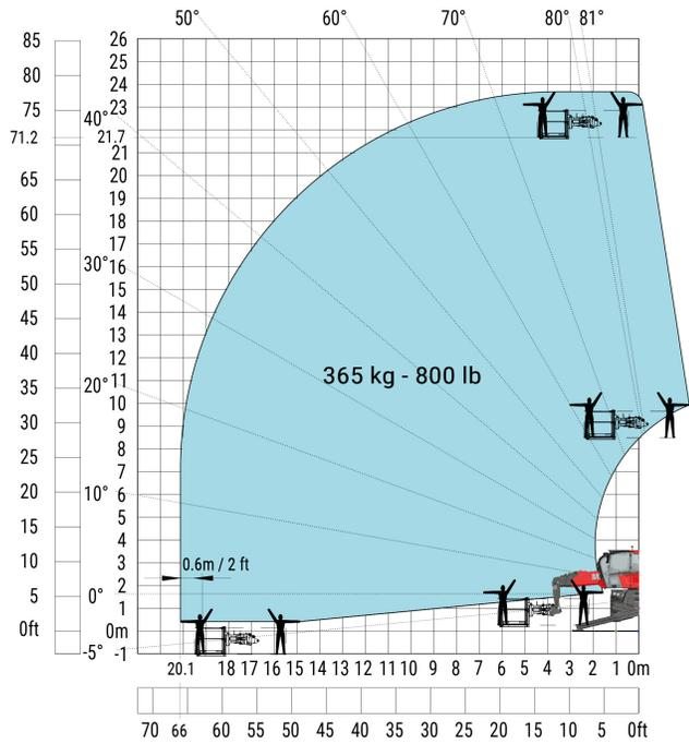
Drehung an abgesenkten Stützen mit 1000 kg Arbeitskorb
