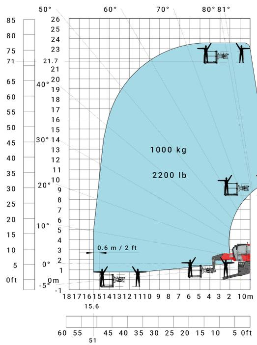
Drehung mit abgesenkten Stützen mit 3D positiv
