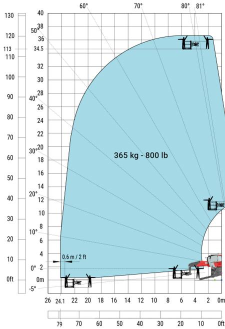
Drehung mit abgesenkten Stützen mit 3D positiv
