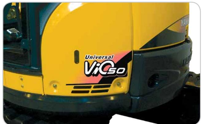
> Die Form des Gegengewichts wurde entworfen um die Seitenbleche gegen eventuelle Stöße zu schützen. Gussteile wurden zusätzlich an der rechten und linken Seite des Oberwagens eingebaut, um den Oberwagens besser zu schützen.
