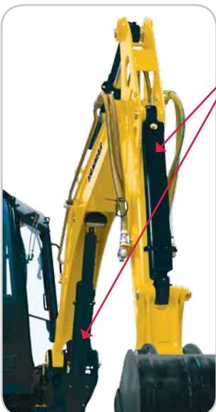
> Vollständiger Schutz des Zylinders (Kolbenstange + Zylinder) durch hoch-elastische Stahlplatten um eventuelle Beschädigungen durch Stöße abzuwehren.
