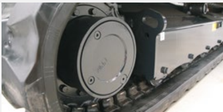
Anschlagösen für den Transport
