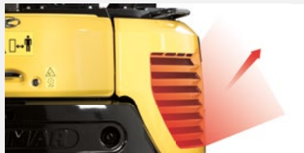
Nach oben abgehende Kühlluft des Motors (Schutz von Personen und Pflanzen)
